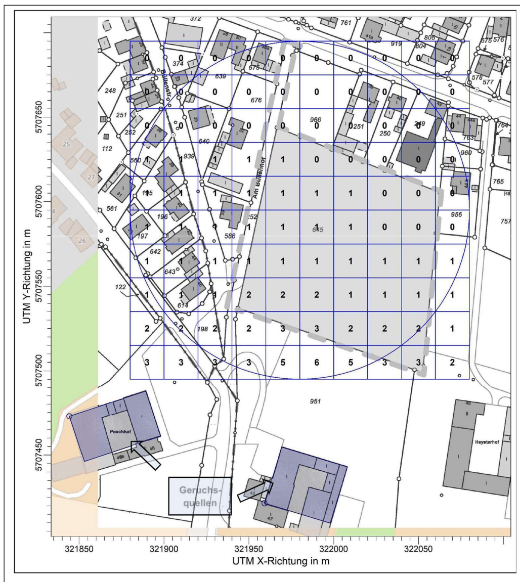
Abbildung 13 Relative Häufigkeit von Geruchsstunden (belastigungsrelevante Kenngröße)
